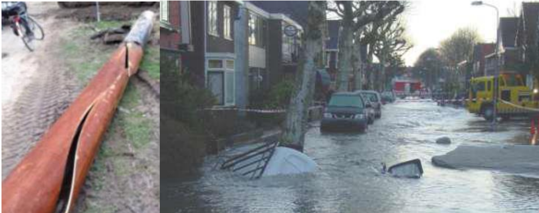
Figuur 56: Veroudering kan ervoor zorgen dat een polymere pijp voor de watertoevoer plotseling breekt.
