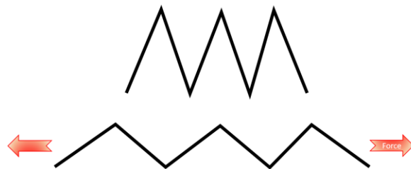
Figuur 16: De rotatie van ketensegmenten resulteert in een grote vervorming. De relatieve positie van de moleculen verandert niet.
